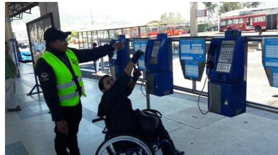
MODULACIÓN DE 5 TELÉFONOS PÚBLICOS SIN QUE EXISTA 1 INSTALADO A BAJA ALTURA
