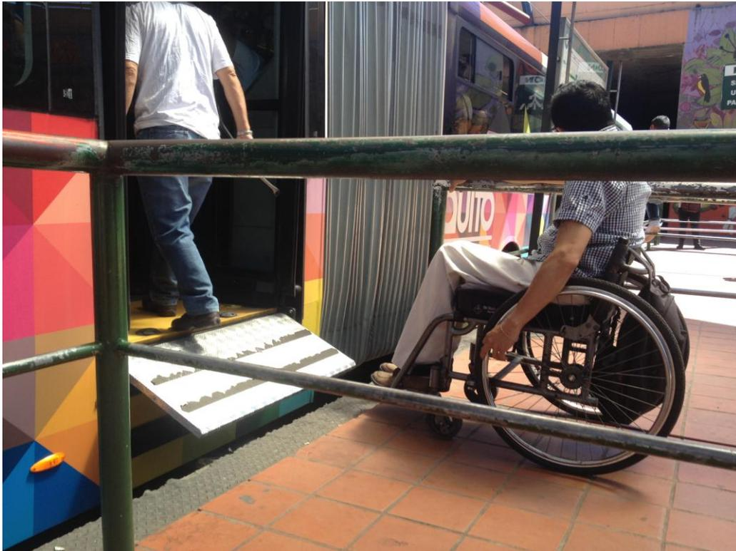
La imagen identifica el principal problema actual que sufren las personas con movilidad reducida toda vez que las nuevas unidades de transporte por su altura ocasionan que su rampa y sistema de inclinación se junten con el nivel de la parada ocasionando una pendiente muy marcada y totalmente inaccesible.
